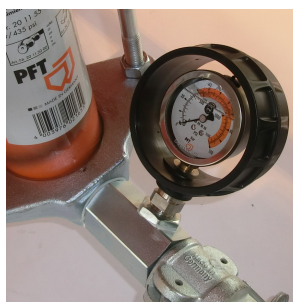
Рис. 42: Манометр давления раствора
