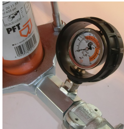
Рис. 26: Манометр давления раствора
